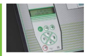
Der manuelle Motorbefehl ermöglicht eine sanfte Traversenverschiebung, um vor Beginn der Messungen in Position zu gelangen oder um erste Versuche einzustellen.
